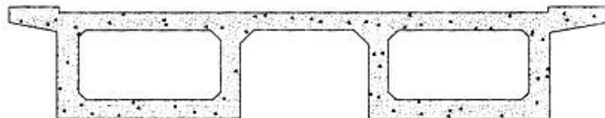
(d) Box girder, two cell (30 to 70 m)
